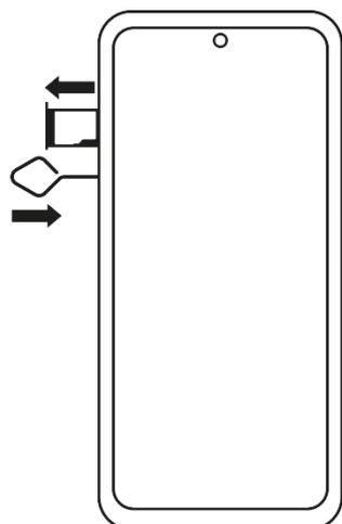
Insertar el pin que trae como accesorio en el orificio de la izquierda como indica la imagen, inmediatamente después se extraerá el slot para colocar el SIM o la tarjeta microSD™.
